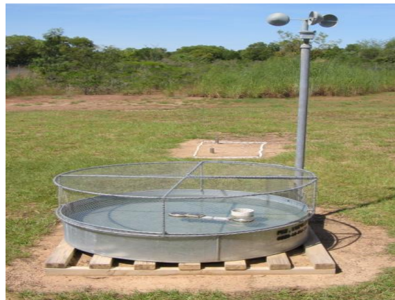
شكل (1) حوض تبخر من الصنف us.wb المستخدم من قبل دائرة الأنواء الجوية الأمريكية
