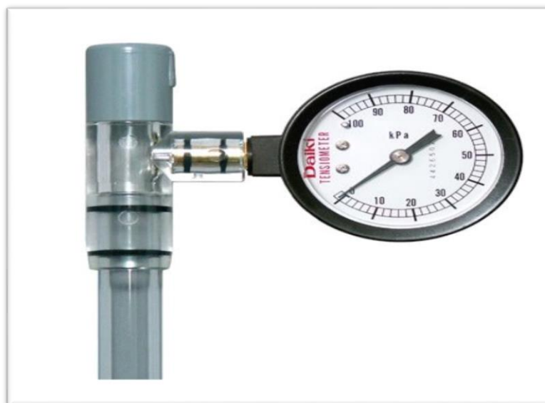
مانوميتر أو مقياس لقوة التفريغ الذي ينشأ نتيجة لخروج الماء من خلال مسام الوعاء الخزفي
