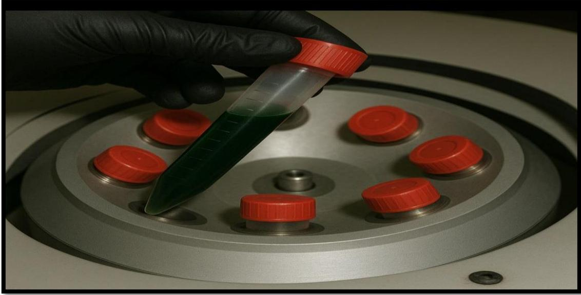
الشكل رقم (4) طريقة عزل المستخلص المائي والزيتي عن الشوائب بواسطة جهاز الطرد المركزي
