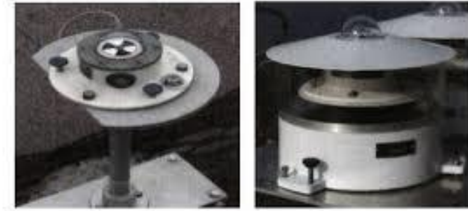
شكل (13-14) : جهاز إيبلي لقياس الإشعاع الشمسي الكلي.
